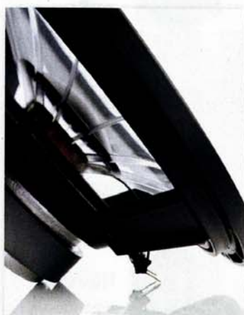
Die größtenteils durchsichtigen Membranen sind netzförmig strukturiert.
